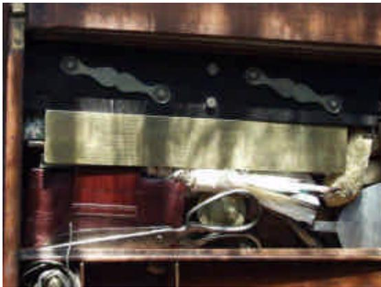
Abbildung 6: Blick in den Skripturkasten eines fliegenden Feldbureaus mit Transversalmaßstab, Schere, Börse, Federkiel und Parallel-Lineal, Freilichtmuseum Kiekeberg 2007
